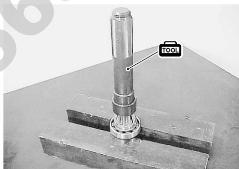
**BEVEL PINION GEAR PILOT BEARING**
