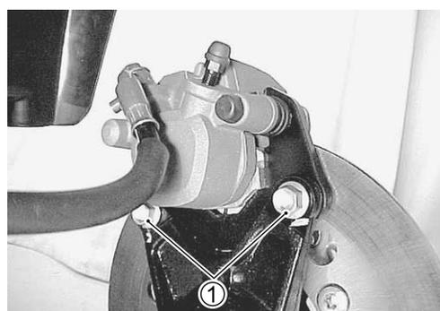
**BRAKE CALIPER REMOVAL AND DISASSEMBLY**
