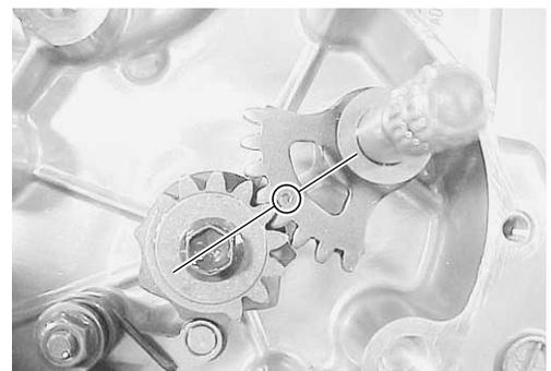
**STARTER DRIVEN GEAR/IDLE GEAR**
