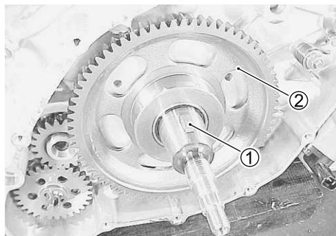
**WATER PUMP DRIVE/DRIVEN GEAR**
